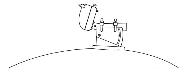
Перпендикулярность расположения мотора можно проконтролировать с помощью рулетки, измеряя расстояния с двух сторон до краев антенны.
