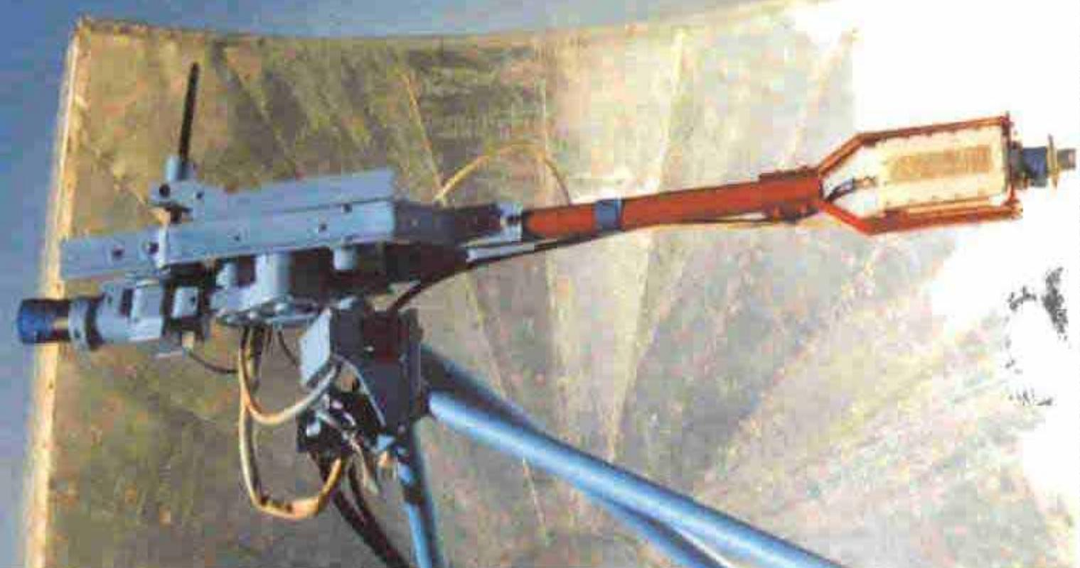
творительные результаты совместной работы сканирующего облучателя со сферическим зеркалом. Размеры антенны и ее каркас могут быть без труда пересчитаны для любых других стандартных размеров зеркала, а сама антenna
